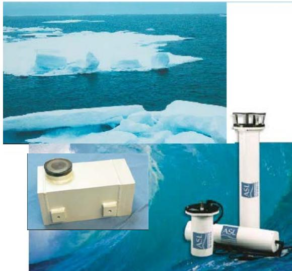
Для определения ледовых нагрузок, объемов генерации льда, баланса масс в океане необходимы данные о толщине льда. Акустические измерители толщины льда IPS5/SWIP делает возможным проведение точных измерений и получение необходимых данных для:
