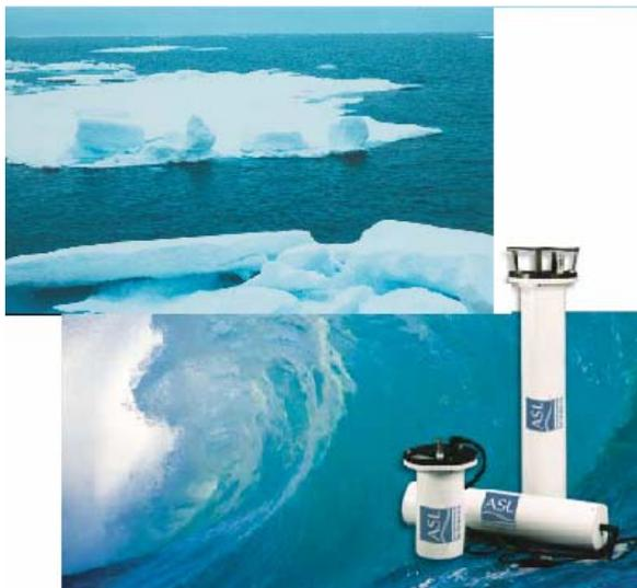
Для определения ледовых нагрузок, объемов генерации льда, баланса масс в океане необходимы данные о толщине льда. Измеритель толщины льда IPS 5 делает возможным проведение точных измерений и получение необходимых данных для:
