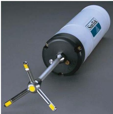
Прочная конструкция, высокое качество сборки в совокупности с отточенной технологией ADV®, защищенной патентами, делают эти уникальные «точечные» измерители течений фирмы SonTek востребованными как для научных исследований, так и инженерных разработок и изысканий.
