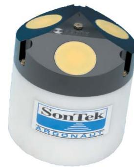
Argonaut-XR 1,5 МГц представляет особую ценность для выполнения профилирования течений в реках и прибрежных морских районах на относительно небольших глубинах. Его небольшой размер, надежное качество сборки и гибкая архитектура, делают этот прибор привлекательным, как для измерений в режиме реального времени, так и при автономных развертываниях.
