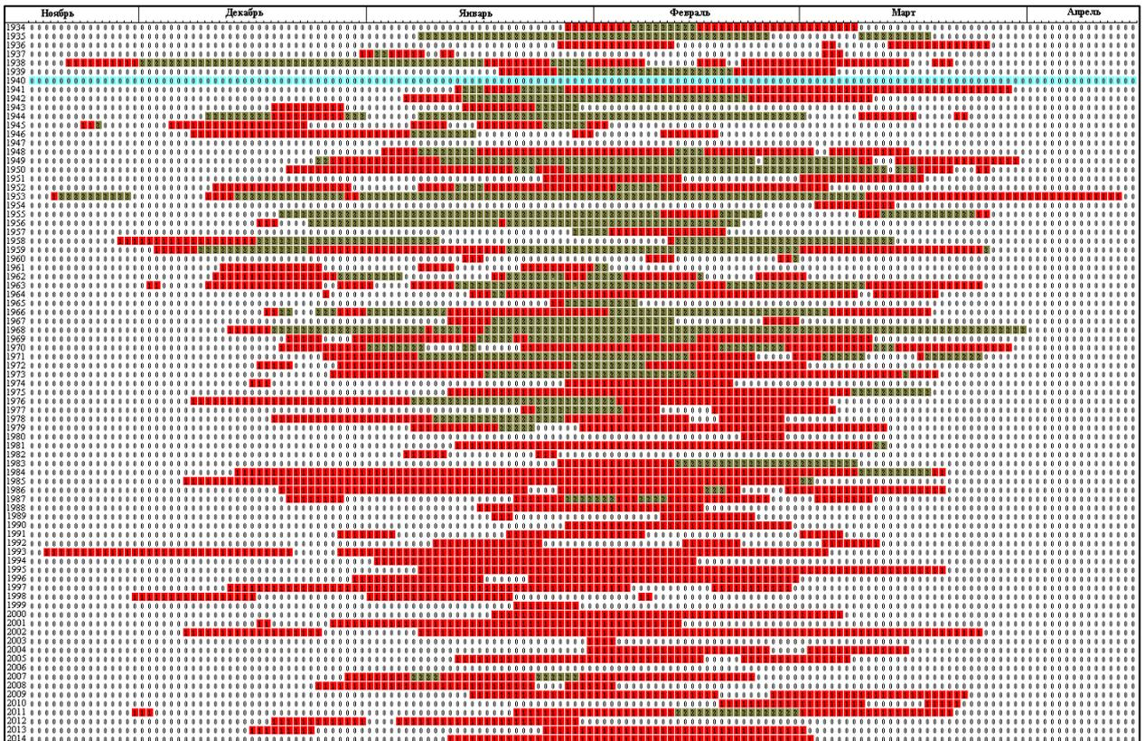
а) Временное распределение плавучего льда и припая на акватории месторождения Ракушечное. ■ - припай, ■ - плавучий лед, □ - пропуск.
